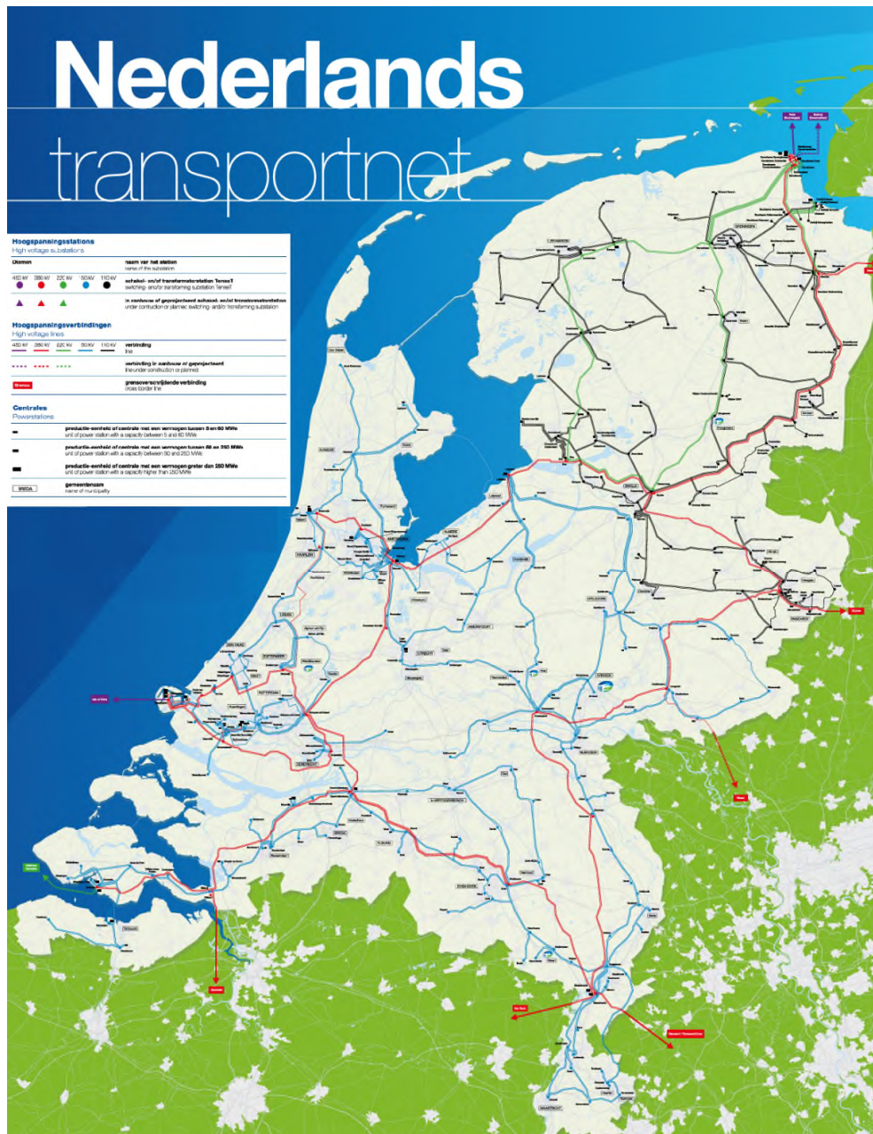
Figuur 2.1 Overzicht van het (extra) hoogspanningsnet [3].
